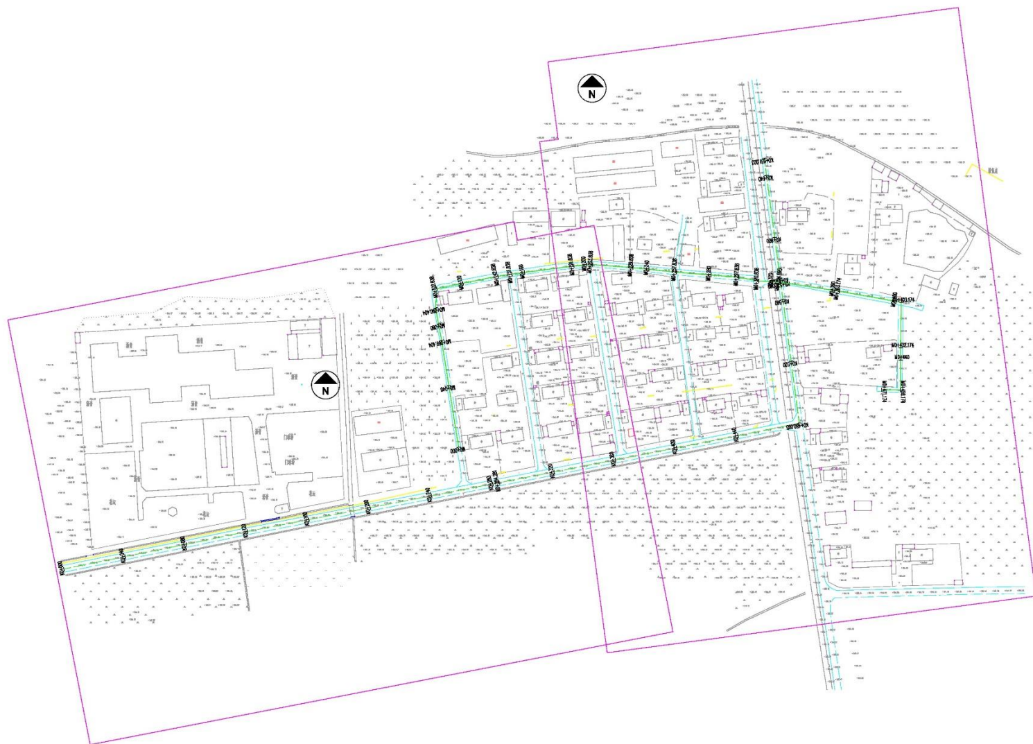
附图 3：平安村管网走向示意图
